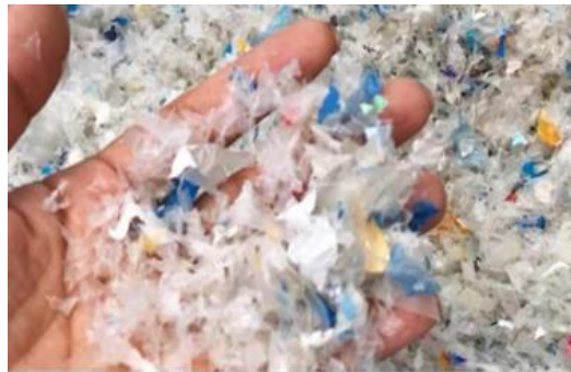
รูปที่ 1 อนุภาคพลาสติก HDPE ที่ผ่านการทำความสะอาดและตัดย่อย
